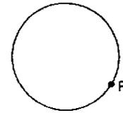
Partiendo de este punto y con una abertura -- del compás igual al radio de la circunferen-- cia trazada, se marcan puntos sucesivos de la misma (Q, R, S, T y U).
