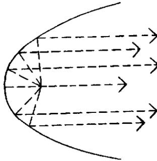
El corazón del telescopio Hale en el Monte Palomar es un espejo parabólico de 5 metros de diámetro.
